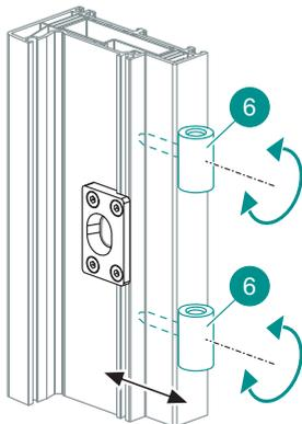
**□** Andruckverstellung / Depth adjustment / Réglage de la compression de joint / Drukaanpassing:
