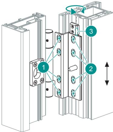
**◇** Höhenverstellung / Height adjustment / Réglage vertical / Hoogte afstelling:
