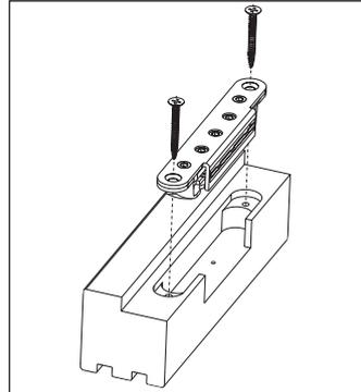
Das Aufnahmeelement im Rahmen gemäß Montageanleitung "VARIANT VX - Aufnahmeelemente" montieren.
