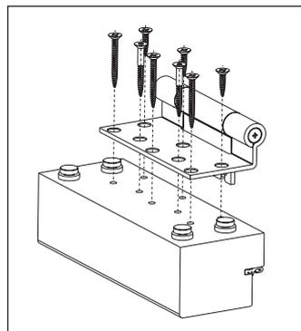
Den Bandlappen an der Tür mit 5 Schrauben  $\varnothing$  6 mm befestigen. Beiliegende Sicherungsschrauben ergänzen.
