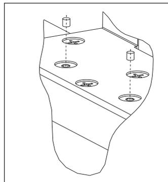
Als Sicherung gegen ein Demontieren des Bandes die beiden Stahlstifte in die Sicherungsschrauben einschlagen.
