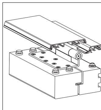
Die Aluminium-Schalen montieren. Die Dichtung in der Länge des Bandes ausschneiden.
